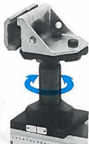
360° drehbar, daher auch zur Verankerung von Fahrzeugen ohne gleichlaufende Schweißfahnen geeignet (z.B. Peugeot J9). Durch die stabile Fahrzeugverankerung können Richtarbeiten an leichten Schäden auch ohne Aufbau eines Richtwinkelsatzes ausgeführt werden.
