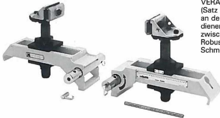
Schnellverstellung in 3 Ebenen, Arretierung durch Exzenter. Jede Verankerung ist freistehend und nimmt keinen Platz auf der Richtbank ein.
