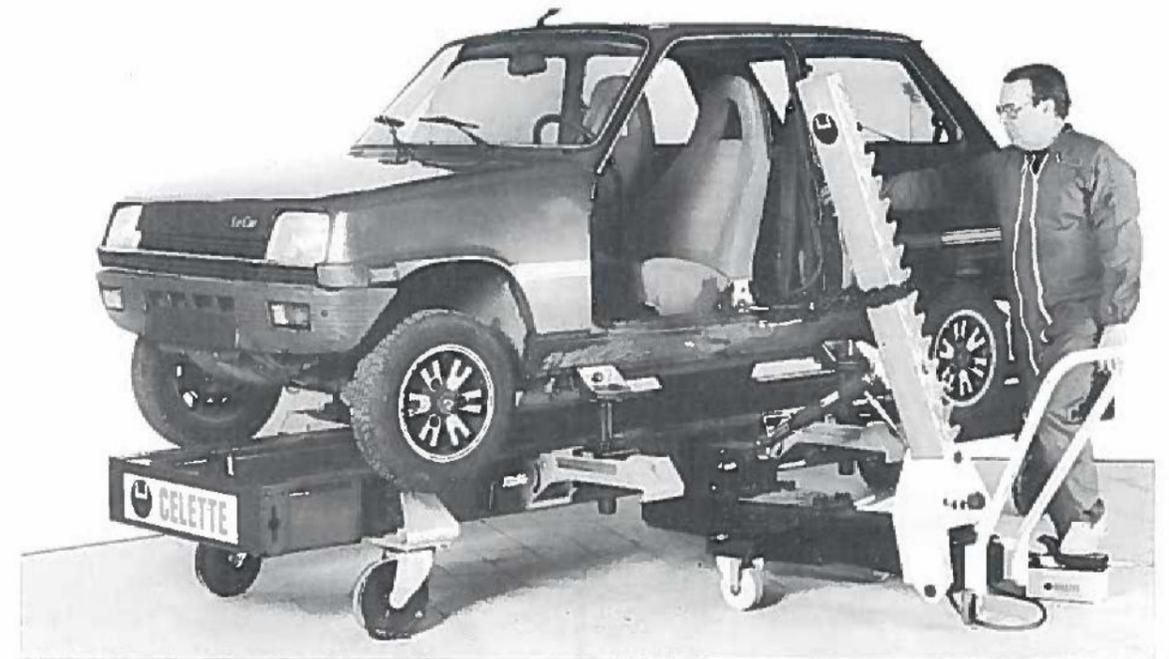
**Leichte Unfallschäden** die keine Verformung des Unterbaus verursacht haben. Teilrichtarbeiten ohne Kontrollsystem (Richtwinkelsätze oder Meßgerät). Das Fahrzeug ist nur mittels der Verankerungen festgehalten. Die Werkbank in der Karosserie-Abteilung.
