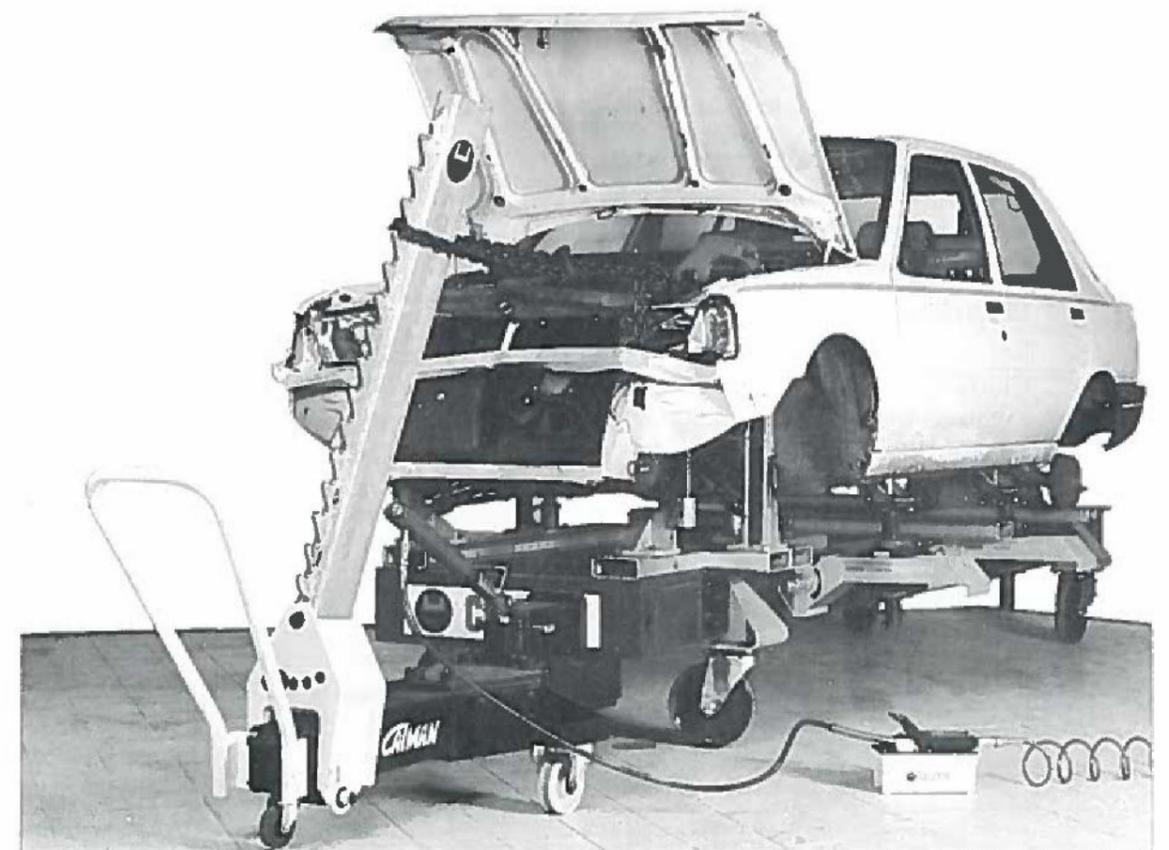
**Größere Unfallschäden.** Reparatur mittels eines Multi-Z.u. Terminal-Richtsatzes. Die Verwendung der Verankerungen ist für eine gute Verteilung der Zugkräfte angebracht.
