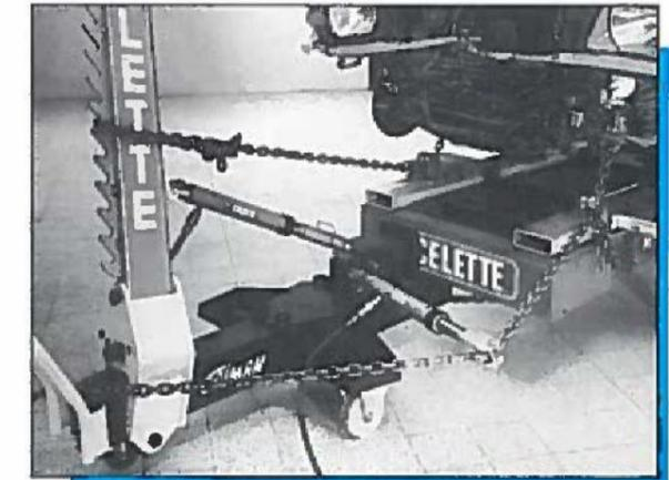
Doppelter Zug nach unten (mit Umlenkklager 947.910) und Diagonalzug (mit Umlenkrolle ATD.01.801).
